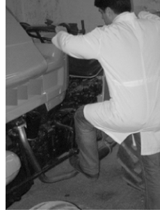
Şekil 15. Eksoz borusunun merdiven olarak yanlış kullanımı
