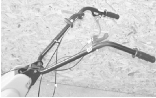
Şekil 2. Motorlu çapanın sevk ve idaresinde kullanılan gidon.
