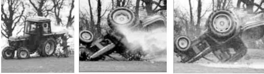
Şekil 4. Ağırlık merkezi ve ekipmanın oluşturduğu devrilme riskleri
